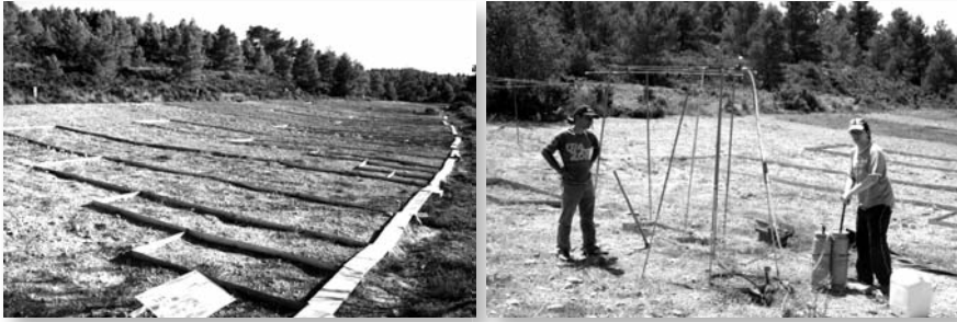
Figura 2. Vista de los trabajos de medición de la erosión mediante simuladores de lluvia (derecha) y parcelas de erosión (izquierda).
